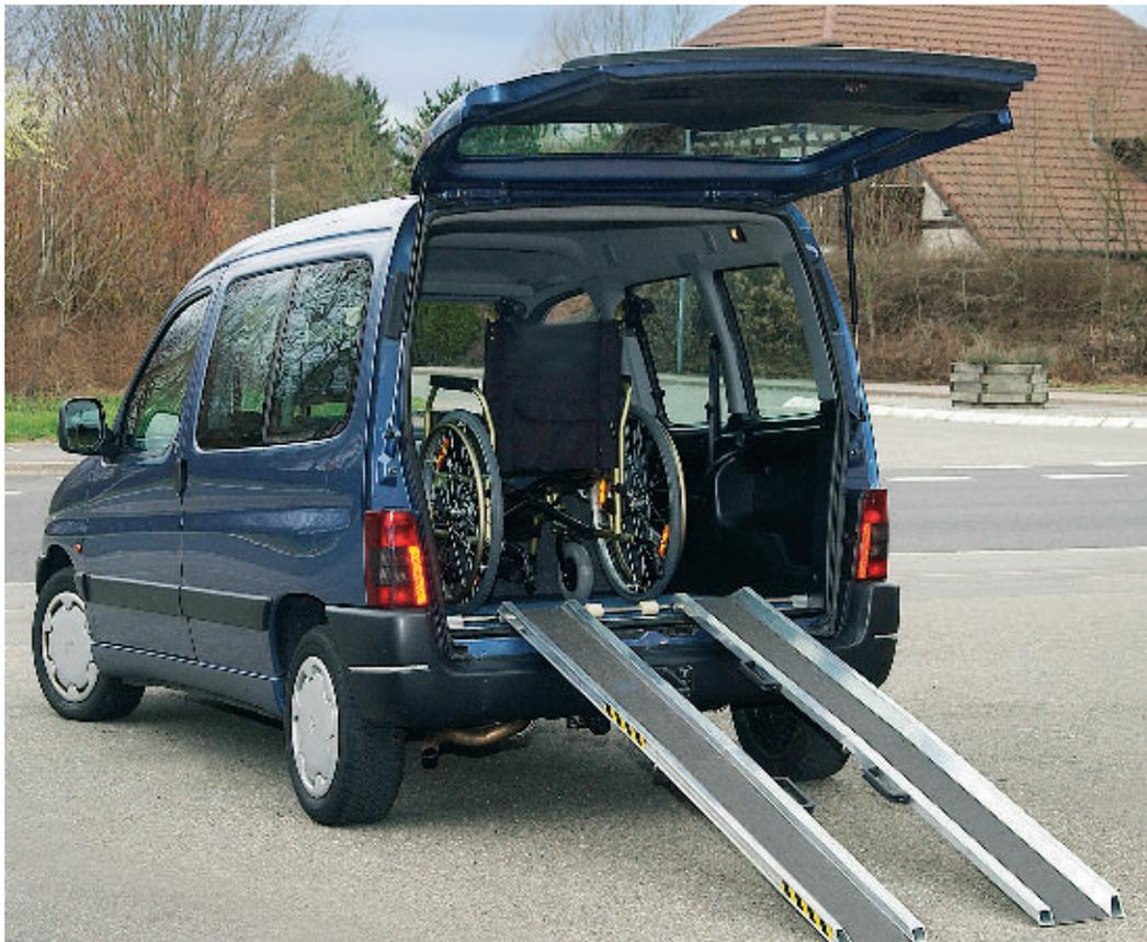
Die ALTEC-Auffahrhilfen RAS-W aus Aluminium sind ein sicheres und schnelles Hilfsmittel für Betreuer. Die Schienen laufen kugelgelagert auf einer rostfreien Stahlwelle, die fest im Fahrzeug montiert wird. Während der Fahrt sind die Schienen zusammengeklappt und werden stehend in einer Halterung gesichert. Die Fahrfläche ist mit einem rutschsicheren Korundbelag beschichtet.
